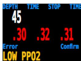
Ce message apparaîtra si la ppO<sub>2</sub> moyenne est inférieure à 0,4 b (0,19 b pour le CO) pendant plus de 30 secondes.
