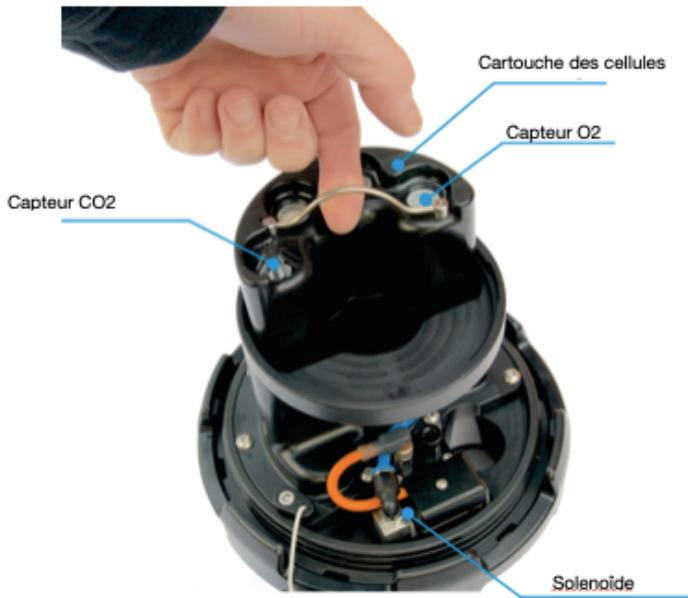
Trois capteurs d'oxygène et un capteur de CO<sub>2</sub> sont placés dans le support de cellules facilement amovible, ce qui facilite le séchage, la vérification ou le remplacement des capteurs.
