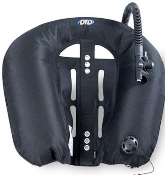
La *wing* est équipée d'un inflateur de gonflage manuel standard alimenté en gaz par un flexible moyenne pression relié au répartiteur de diluant. L'inflateur est reliée à la *wing* par un tuyau annelé.
