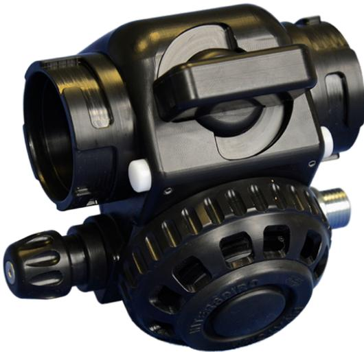
La vanne de commutation CC/OC de la BOV permet de passer du circuit fermé (mode CC) au circuit ouvert (mode OC) et est facile à utiliser en tournant le volant situé à l'avant de la BOV.
