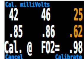
Les bons capteurs doivent être dans la plage de 35 à 65 mV au niveau de la mer dans de l'oxygène à 100%. Un capteur échouera à l'étalonnage s'il n'est pas dans la plage de 30 mV à 70 mV. Cette plage admissible s'ajuste automatiquement en fonction des changements de FO<sub>2</sub> et de la pression barométrique. En dehors de la plage autorisée, une lecture en millivolts est affichée en **jaune**.
