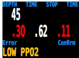
La situation est généralement résolue en augmentant la profondeur de sorte que lorsque l'erreur est constatée, la ppO<sub>2</sub> n'est plus basse.
